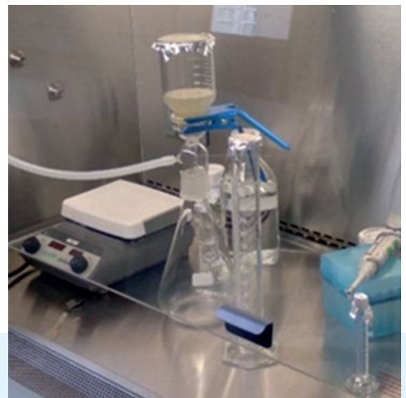
Figura 6. Ensamblaje del sistema para la filtración de muestras de agua residual.
